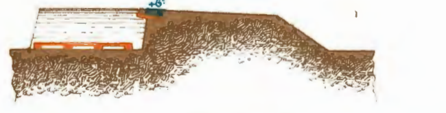
Профиль блиндажа въ стр. онопь (противъ цѣлыхъ гранатъ).
