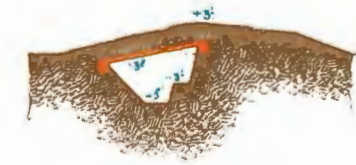
Профиль блиндажа въ стр. онопь (противъ осколковъ)
